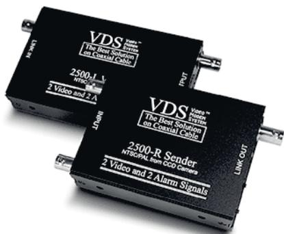
Комплект VDS2500 позволяет передавать два сигнала видео, два сигнала тревоги и питание для двух видеокамер по одному коаксиальному кабелю
