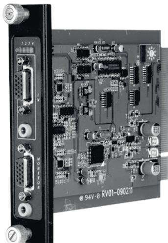
**Одноканальная плата ввода VGA-сигнала и стерео аудиосигнала**
