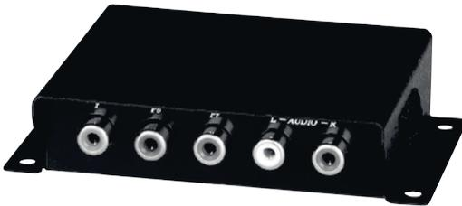
**Комплект для передачи компонентного видеосигнала и стерео аудиосигнала**
