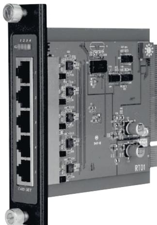
Передает VGA- / компонентный (Y, Pb, Pr) видеосигнал и цифровой аудиосигнал по кабелю витой пары CAT5
