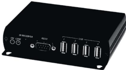
**Комплект (приёмник VKM03T + передатчик VKM03R) для передачи VGA, 4xUSB2.0, RS232, Стерео Аудио и ИК-управление**
