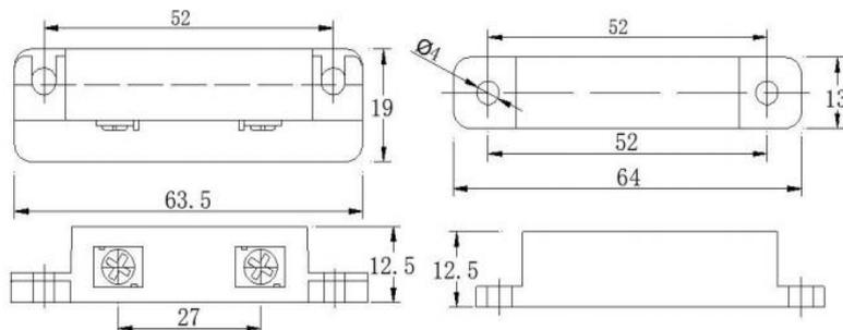
Извещатель магнитоконтактный ST-DM121NC-BR предназначен для контроля положения различных строительных конструкций (дверей, окон, люков, ворот и т.д.). Данное устройство может использоваться в системах охранной сигнализации или контроля и управления доступом.
