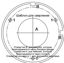
Рисунок 2-11 Шаблон для сверления
