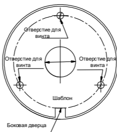
Рисунок 2-1 Шаблон для сверления
