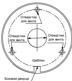
Рисунок 2-8 Шаблон для сверления
